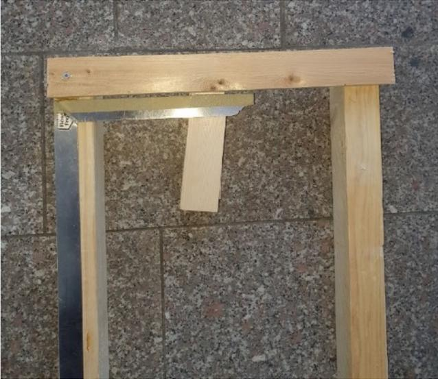
2. Die zweite Querleiste aufschrauben. Dabei zwei FüÙe als Maßabstand einlegen, so passen die FüÙe später gut.
